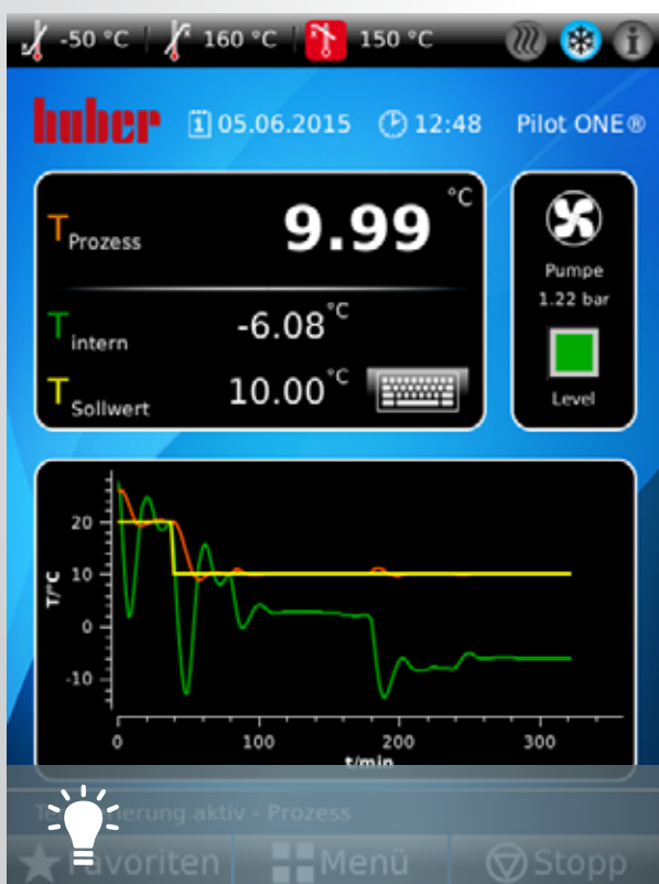
Изображение 1: Типичный дисплей Unistat в процессе контроля температуры под влиянием различных констант времени и экзотермических реакций.
