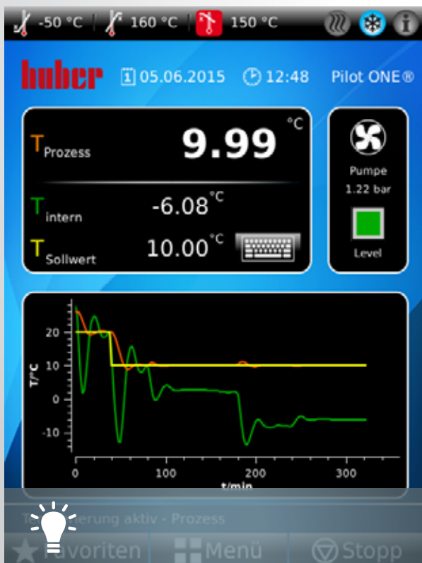
Bild 1: Typische Displayanzeige eines Unistaten bei einer Prozesstemperaturregelung mit unterschiedlichen, konstanten exothermen Reaktionen.
